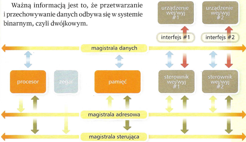
Ryc. 1. Schemat blokowy komputera według von Neumanna
